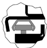
Slika 63: C-stebriček in vodilni valji
