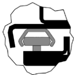
Illustration 63: Glissière en C et galets de guidage
